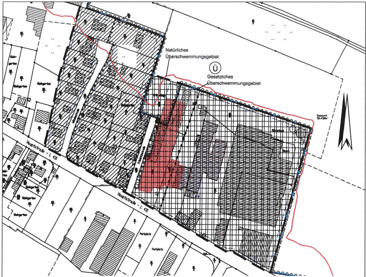
Abb. 1: Gesetzliches Überschwemmungsgebiet und Natürliches Überschwemmungsgebiet (HQ 100 ) gemäß Berechnung im Rahmen des Hydraulischen Nachweises (Stadt-Land-Fluss, Hannover) der Weser im Plangebiet
